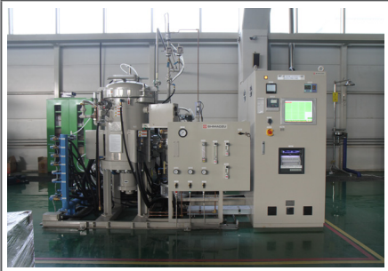
수소분사 진공로 | Hydrogen spraying vacuum furnace
