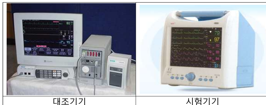
<그림147> 혈압측정용 대조기기 및 시험기기
